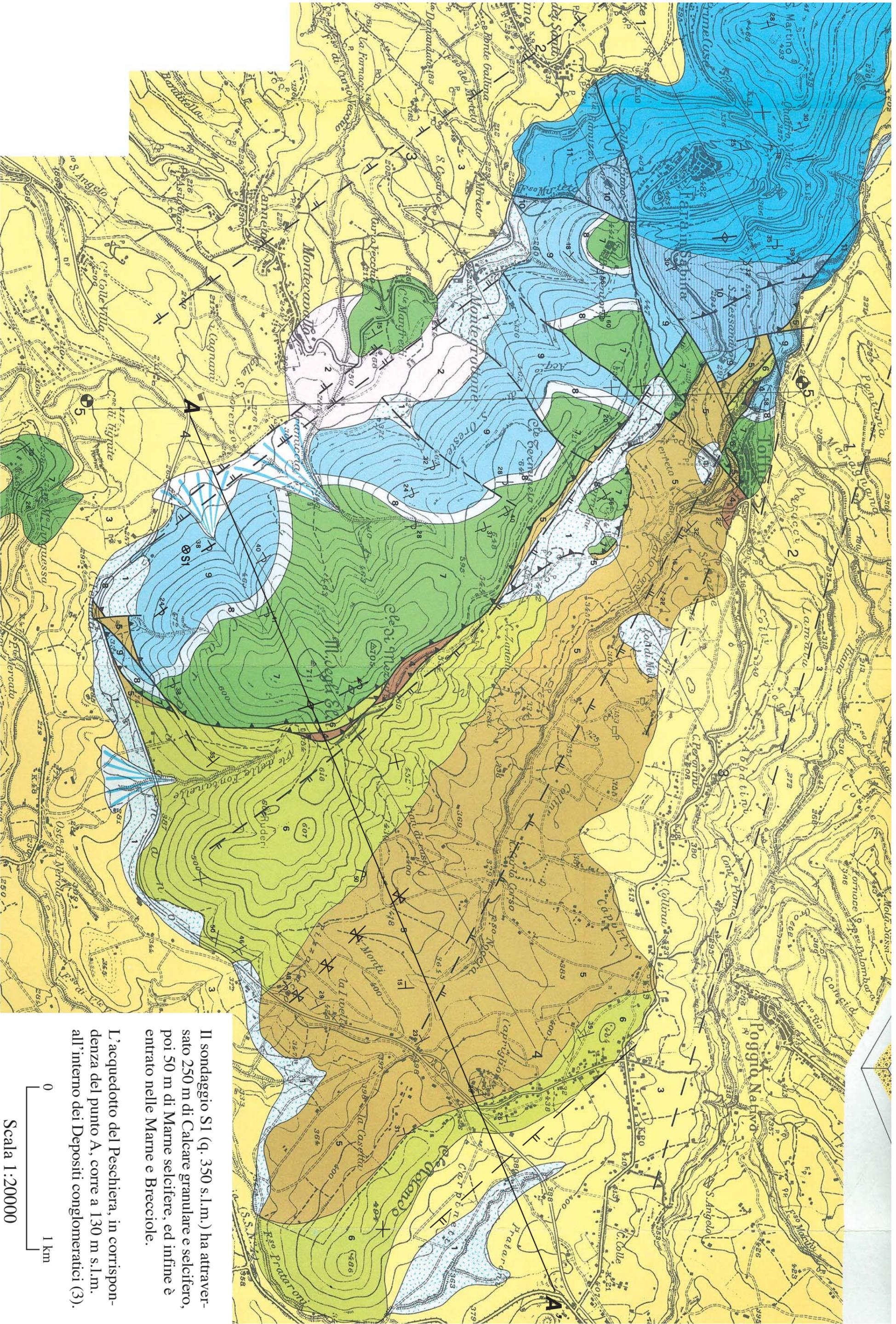
Il sondaggio S1 (q. 350 s.l.m.) ha attraversato 250 m di Calcare granulare e selcifero, poi 50 m di Marne selcifere, ed infine è entrato nelle Marne e Brecciole.
