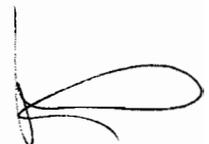
*Caratteristiche della sollecitazione relative a carichi verticali di valore unitario (1 kN/m) uniformemente distribuiti sulle travi*
