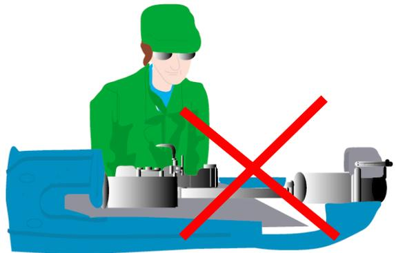
Posizione corretta dell'operatore, ma sono assenti gli schermi di protezione della macchina.
