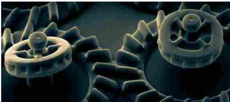
Alcuni batteri geneticamente modificati e in grado di produrre proteorodopsina possono essere utilizzati come minuscoli propulsori in micromacchine invisibili all'occhio umano e la cui velocità di rotazione può essere finemente regolata illuminando con luce verde di intensità controllabile. Lo studio, condotto da un team di ricercatori di Nanotec-Cnr e dell'Università Sapienza di Roma, è stato pubblicato sulla rivista Nature Communication
