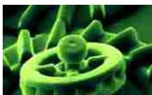
La **micromacchina** ibrida, cio fatta di una parte biologica e una parte sintetica, stampata in 3D su scala nanometrica con un materiale plastico. La parte biologica invece costituita da **batteri** ...
