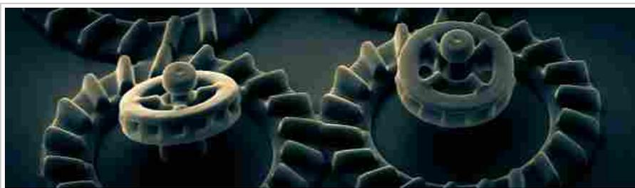
Alcuni batteri geneticamente modificati e in grado di produrre proteorodopsina possono essere utilizzati come minuscoli propulsori in micromacchine invisibili all'occhio umano e la cui velocità di rotazione può essere finemente regolata illuminando con luce verde di intensità controllabile. Lo studio, condotto da un team di ricercatori di Nanotec-Cnr e dell'Università Sapienza di Roma, è stato pubblicato sulla rivista Nature Communication
