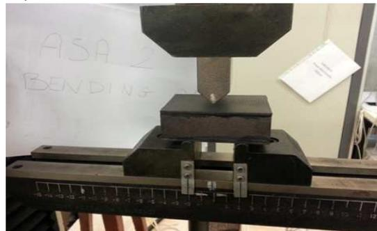
Fig. 3 Prova di flessione della struttura / Bending on sandwich.
