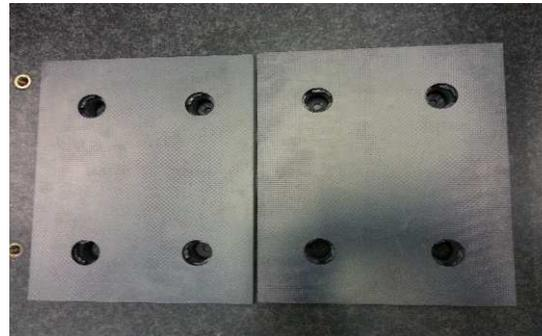
Fig. 1 Modello di qualifica della protezione termica.
