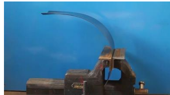
Fig. 4 Prototipo: configurazione di equilibrio stabile vincolata in assenza di carichi applicati, punto O di Fig. 2.
