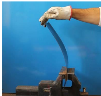
Fig. 5 Prototipo: prima configurazione di equilibrio stabile vincolata a un carico fissato, punto C1 di Fig. 2.
