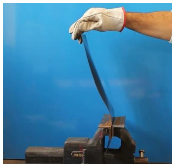
Fig. 6 Prototipo: seconda configurazione di equilibrio stabile vincolata a un carico fissato, punto C2 di Fig. 2.
