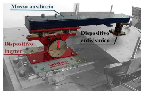
Fig. 1 Foto del prototipo del sistema per la mitigazione delle vibrazioni proposto testato su tavola vibrante.
