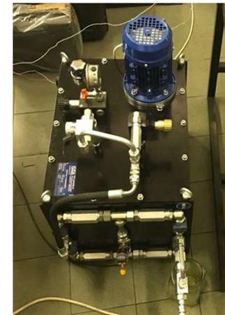
**Fig. 5** Immagine della centralina oleodinamica per il prototipo installato in laboratorio.
