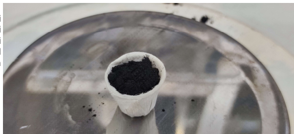
Fig 3. Campione di riferimento fossile di carbone in un cono di cellulosa, pronto per il trattamento in un ossidatore di campioni
