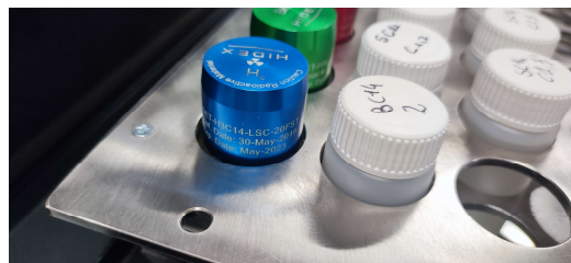
Fig 1. Vassoio di un tipico strumento per la conta a scintillazione liquida. Le fiale colorate sono fonti standard di H-3 (blu), C-14 (rosso) e bianco di riferimento (verde).
