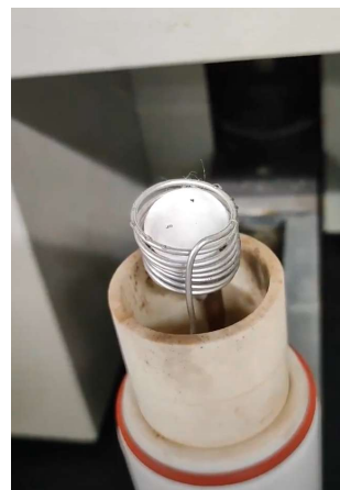
Fig. 2 : Cono di cellulosa posto in una bobina di Pt pronto per essere ossidato a \text{CO}_2 prima della preparazione del campione in scintillazione liquida
