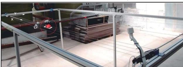
**Fig. 3** Prototipo sperimentato di un sistema per ispezione e manutenzione di una superficie orizzontale.
