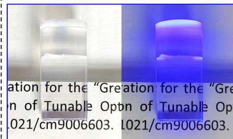
Fig. 5 Scintillatore plastico dopo lavorazione e lucidatura (illuminazione diurna/UV).
