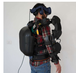
Fig 4. Vista laterale del soggetto che indossa SIDE. Sul retro lo zaino contenente l'elettronica di controllo
