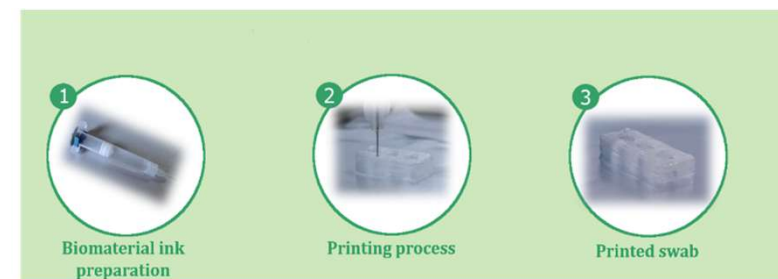
Fig. 3 Diverse fasi della stampa 3D del dispositivo EcoBioSal
