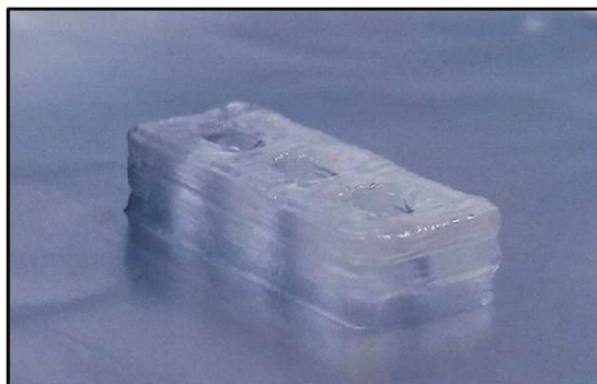
Fig. 1 Dispositivo EcoBioSal a seguito della stampa 3D
