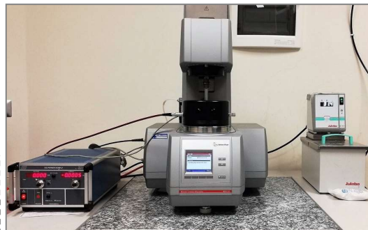
Fig. 1 Setup di misura, comprendente, da sinistra a destra, il generatore di tensione, il reometro rotazionale ed il termostato necessario al raffreddamento della cella Peltier integrata sotto il piatto inferiore.
