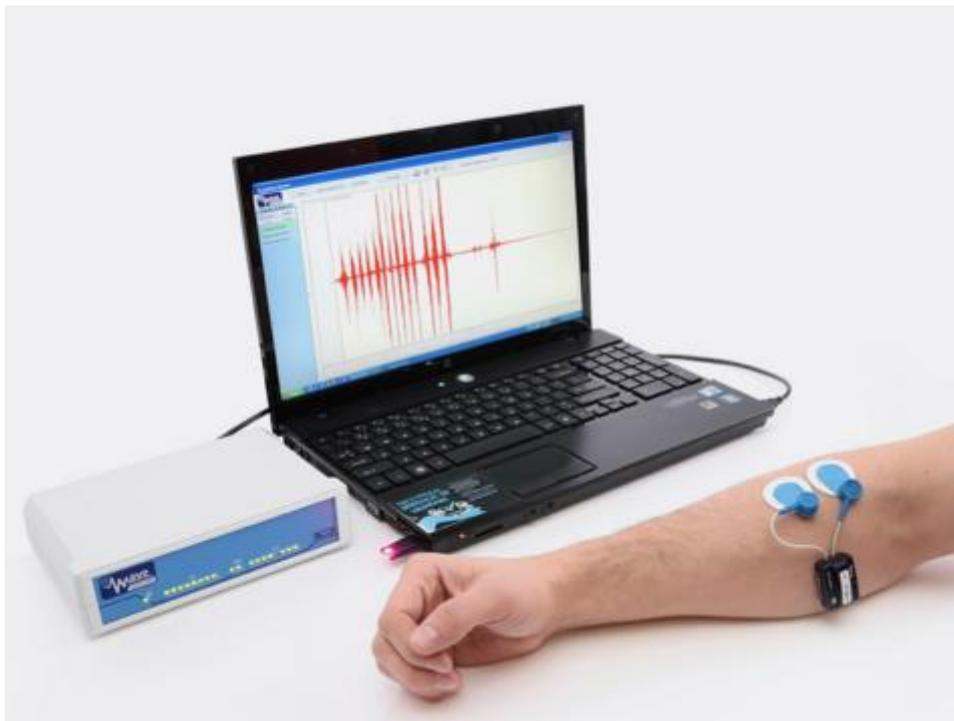
**Fig. 12:** Base ricevente i segnali wireless provenienti dal sensore posizionato sull'avambraccio e collegata ad un personal computer.
