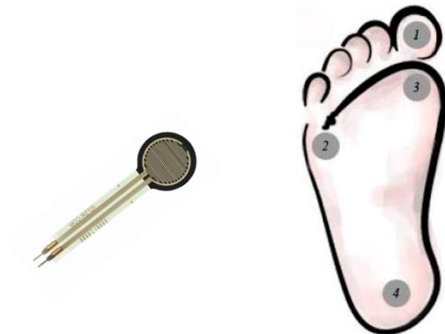
**Fig. 21: posizioni dei Force Sensitive Resistors**
