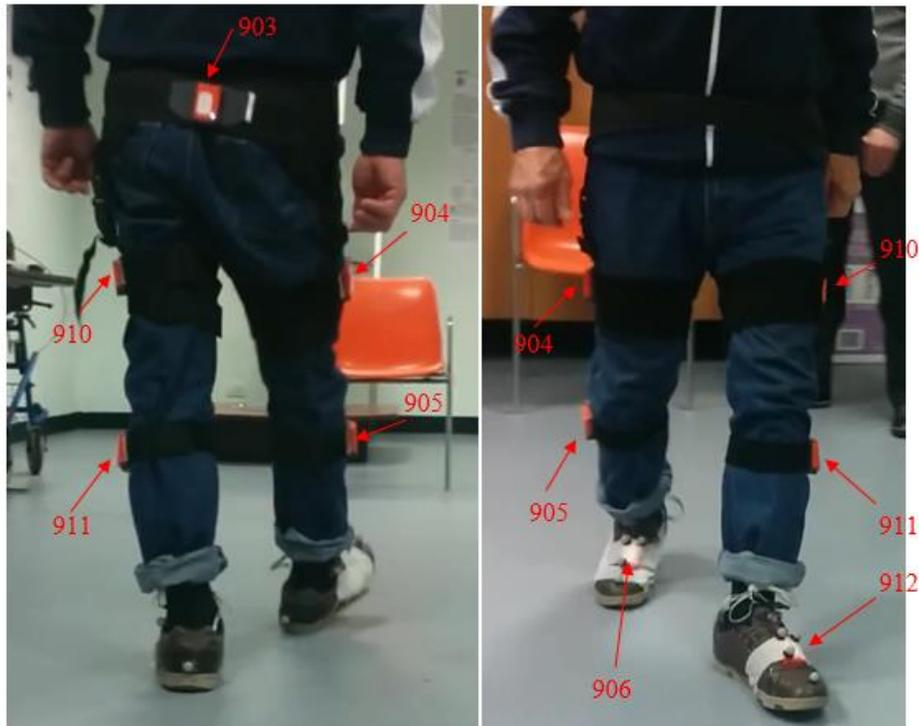
**Fig 20: Posizionamento degli MT trackers.**
