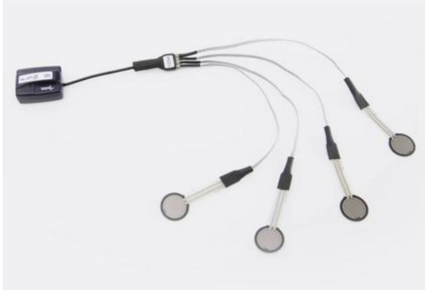
**Fig. 13: Footswitch collegato a quattro sensori FSR.**
